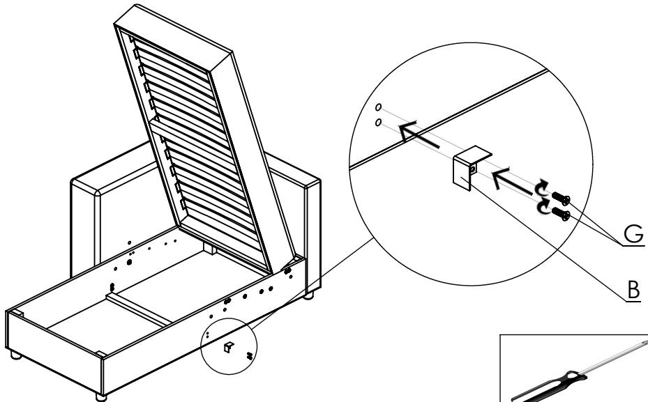
10. Закрепить в посадочных отверстиях с резьбой два z-образных уголка С винтами G M6x20 мм (по 2 шт. на уголок) как показано на рисунке.
