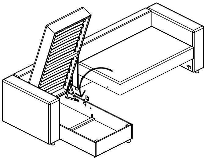
12. Закрепить обе части дивана с помощью мебельных болтов F M8x45 мм с полукруглой головкой (2 шт.). Болты F вставить в отверстия со стороны оттоманки. С обратной стороны зафиксировать болты F гайкой H с шайбой I.
