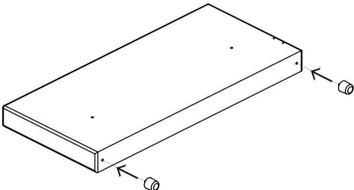
3. Сиденье дивана закрепить в посадочных отверстиях с резьбой к длинной спинке с помощью болтов D M8x60 мм (2 шт.) с шайбами I (2 шт.).
