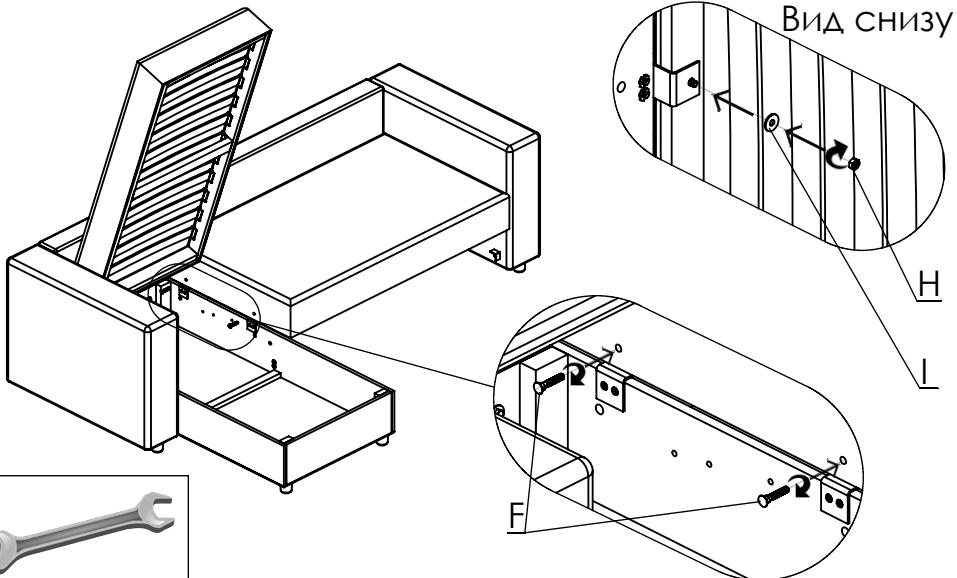
13. Установить выкатную часть дивана. Сначала задвинуть выкатную часть до стопорных уголков. Затем приподнять переднюю часть верх и завести боковые роликовые колеса за стопорные уголки.
