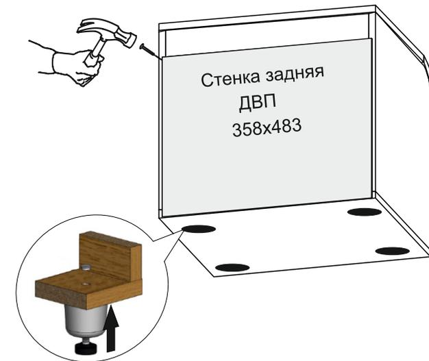
Регулировка высоты осуществляется через сквозное отверстие в дне конструкции, отверстие для регулировки закрывается декоративной заглушкой (в комплекте)
