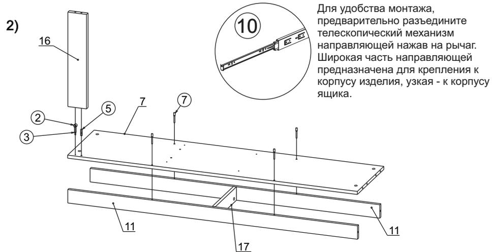
\* В случае несовпадения присадки под направляющие (позиция №10) на деталях 9, 10, 12 и 8, необходимо использовать существующую присадку для определения линий расположения разметки и переноса на нее отверстий (наколок), соответствующих типу направляющих, входящих в комплект поставки. Достаточно 3-х точек крепления для каждого элемента направляющей.
