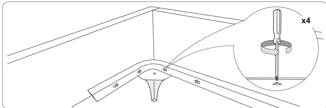
3) Выставить ножки так, чтобы отверстие на ножке совпало с отверстием в обвязке
