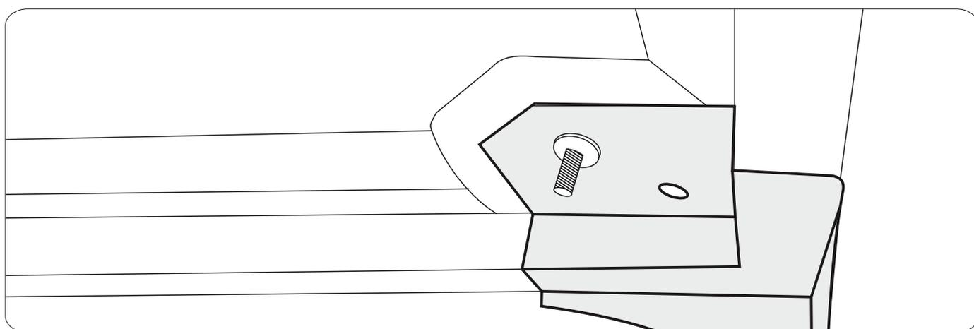
6) Одеть гайку на винт и затянуть винт отверткой
