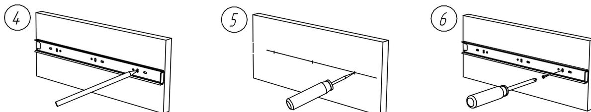
Соблюдая технологические отступы от переднего края деталей необходимо приложить элементы направляющих на линии разметки и отметить, через предусмотренные отверстия в направляющих, места их будущего крепления (достаточно 3ех точек крепления для каждого элемента выдвижной направляющей).
