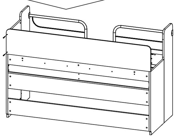
Перед началом соединения кровати и лестницы, необходимо выровнять их высоту в один уровень, так чтобы отверстия в задних стенках изделий были на одном уровне.
