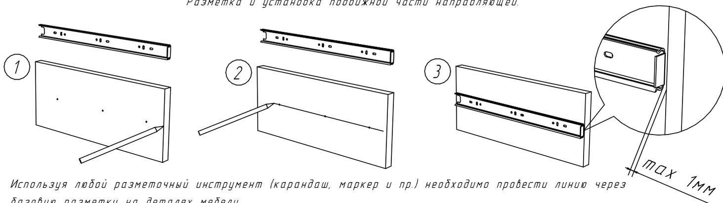
Используя любой разметочный инструмент (карандаш, маркер и пр.) необходимо провести линию через базовую разметку на деталях мебели.
