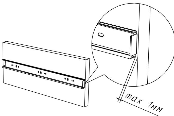
*Перед установкой - проверьте соответствие имеющихся наколов на деталях и отверстий обеих частей направляющей. Размеры указаны от лицевых торцов изделий, так как для неподвижной части направляющей нет единого допуска, размеры приведены отдельно в таблице для каждого изделия в отдельности. В случае обнаружения данного вида несоответствия необходимо действовать, соблюдая следующие рекомендации:*
