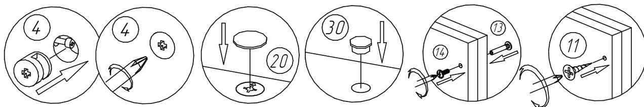
После установки межсекционных стяжек необходимо через оставшиеся отверстия внутри ящиков дополнительно притянуть лестницу саморезами №11.
