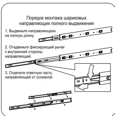
Порядок монтажа шариковых направляющих полного выдвижения
