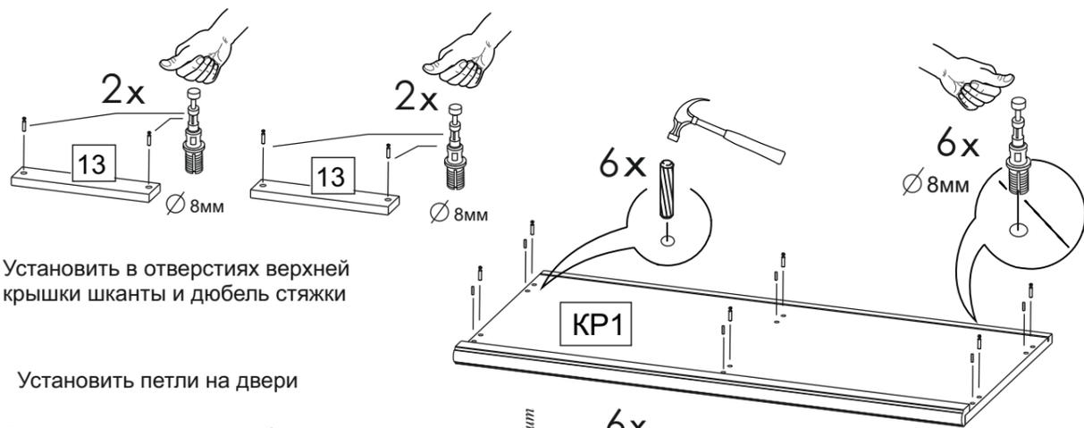
• Установить в отверстиях верхней крышки шканты и дюбель стяжки
