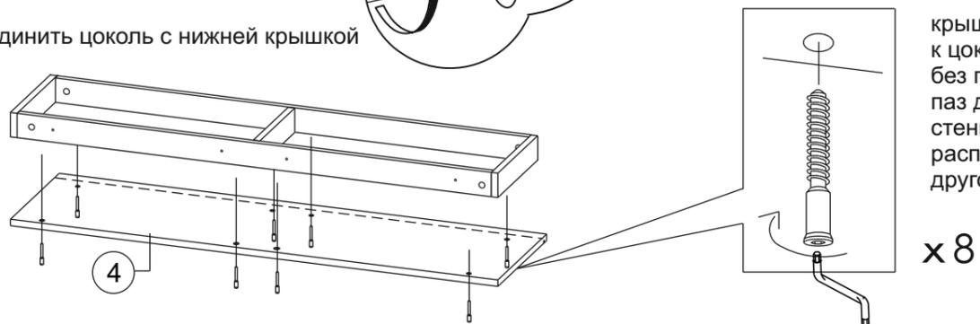
обратить внимание на отверстия в торцах деталей цоколя располагать детали так, чтобы отверстия на всех деталях были повернуты в одну сторону. Они потребуются на последующем этапе сборки, для соединения цоколя с нижней крышкой
