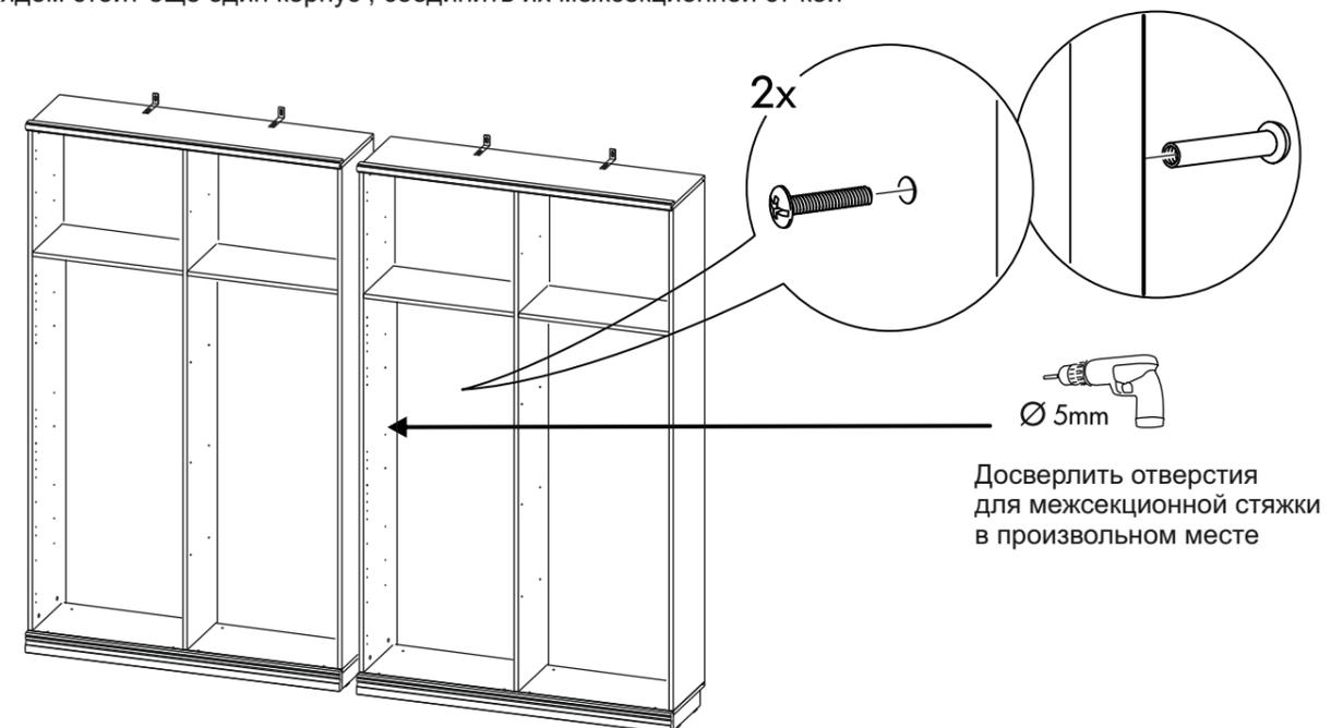
Досверлить отверстия для межсекционной стяжки в произвольном месте
