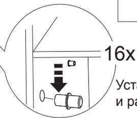
Установка полкодержателей и размещение на них полки
