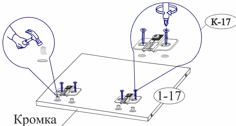
2. Закрепите стенку горизонтальную (поз. 4-17) к перегородкам (поз. 2-17) с помощью винтов-конфирматов (К-7).
