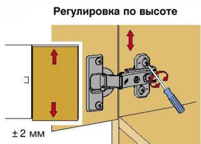
Слегка ослабить крепежные винты ответной планки, выверить по высоте позицию двери. Затем крепежные винты снова затянуть.
