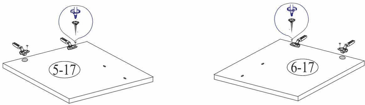
6. Закрепите навески (К-73) к стенкам вертикальным (поз. 1-17) и перегородка (поз. 2-17).
