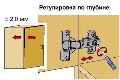
Ослабить крепежный винт и отрегулировать расстояние между дверью и боковиной шкафа. Затем снова затянуть крепежный винт.
