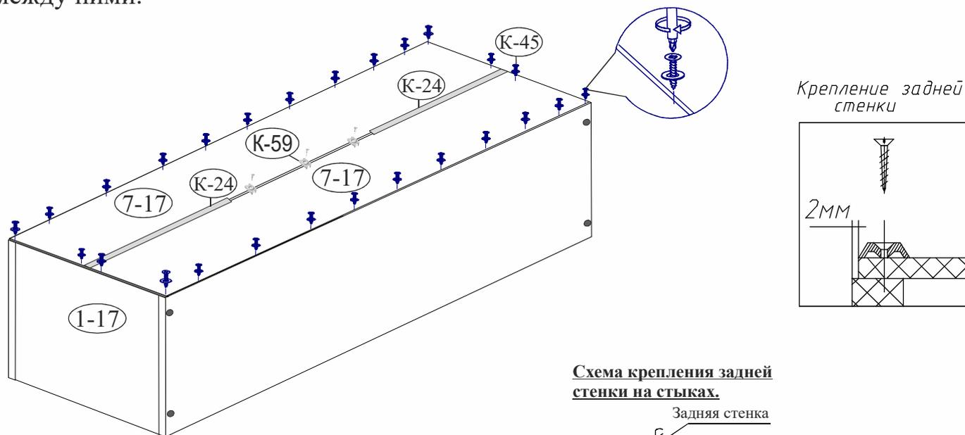
**Схема крепления задней стенки на стыках.**
