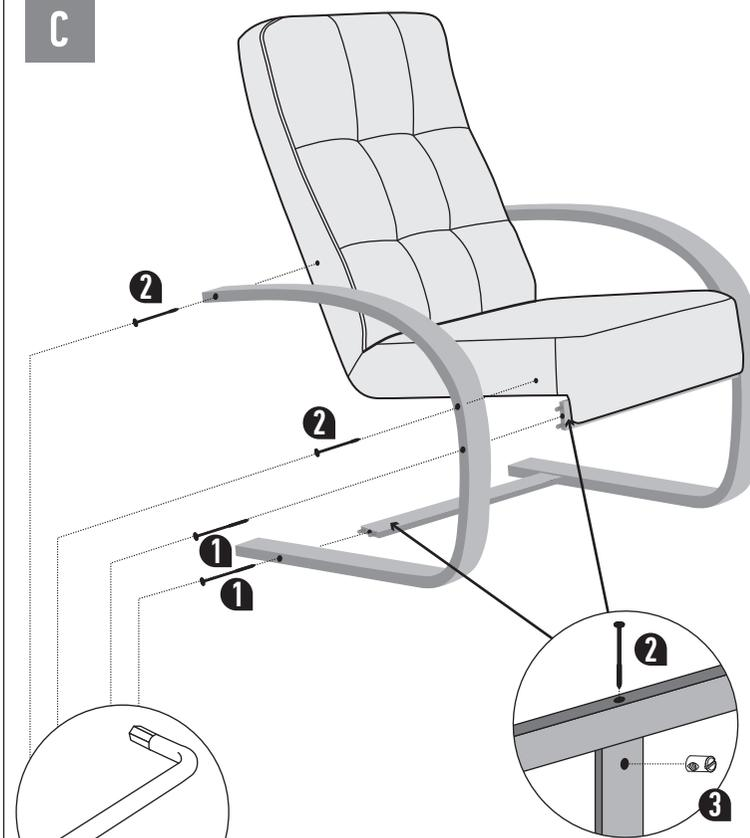
С помощью S-образного ключа и крепежных элементов №2 прикрепите вторую ножку каркаса к поперечным планкам каркаса
