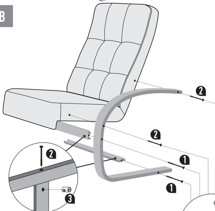
С помощью S-образного шестигранного ключа и крепежных элементов №2 прикрепите ножку каркаса к поперечным планкам каркаса
