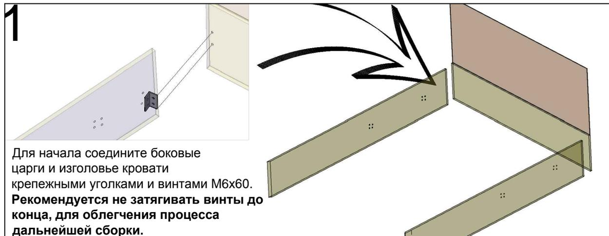
Для начала соедините боковые царги и изголовье кровати крепежными уголками и винтами М6х60.
