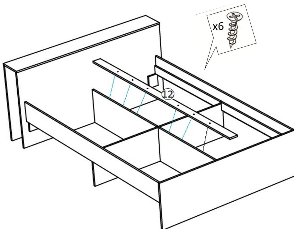
Установить усилитель(поз.12),используя шуруп 3,5х30мм.
