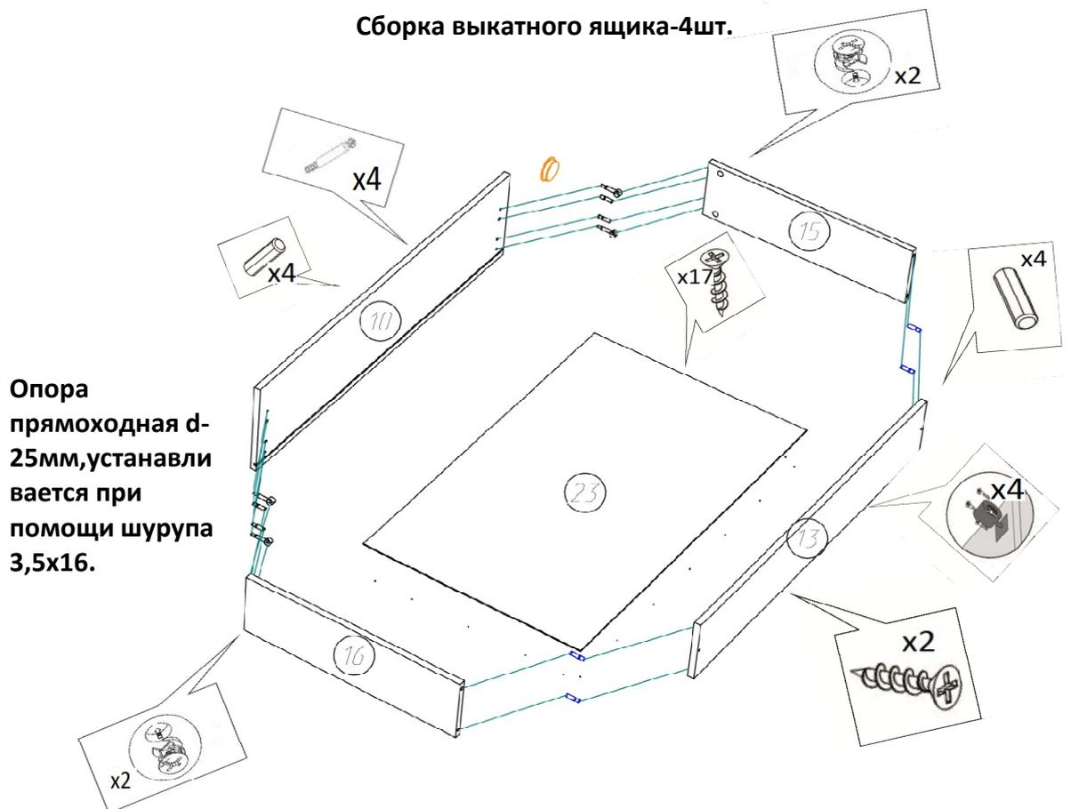
Стенка ящика(поз.13) прикручивается шурупом 4x45мм, пол ящика(поз.23) прикручивается шурупом 3,5x16мм,с шагом 150мм.
