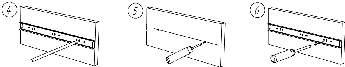
Соблюдая технологические отступы от переднего края деталей необходимо приложить элементы направляющих на линии разметки и отметить, через предусмотренные отверстия в направляющих, места их будущего крепления (достаточно 3-х точек крепления для каждого элемента выдвижной направляющей).
