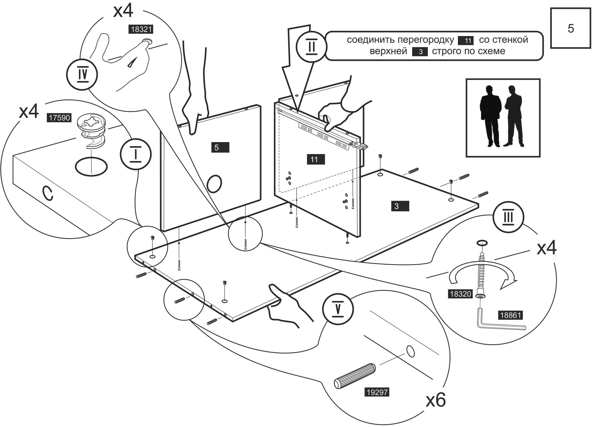
соединить перегородку 11 со стенкой верхней 3 строго по схеме
