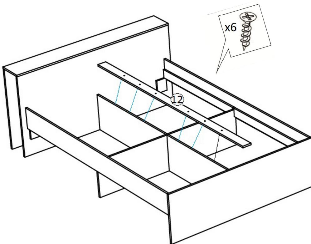
Установить усилитель(поз.12), используя шуруп 3,5х30мм.
