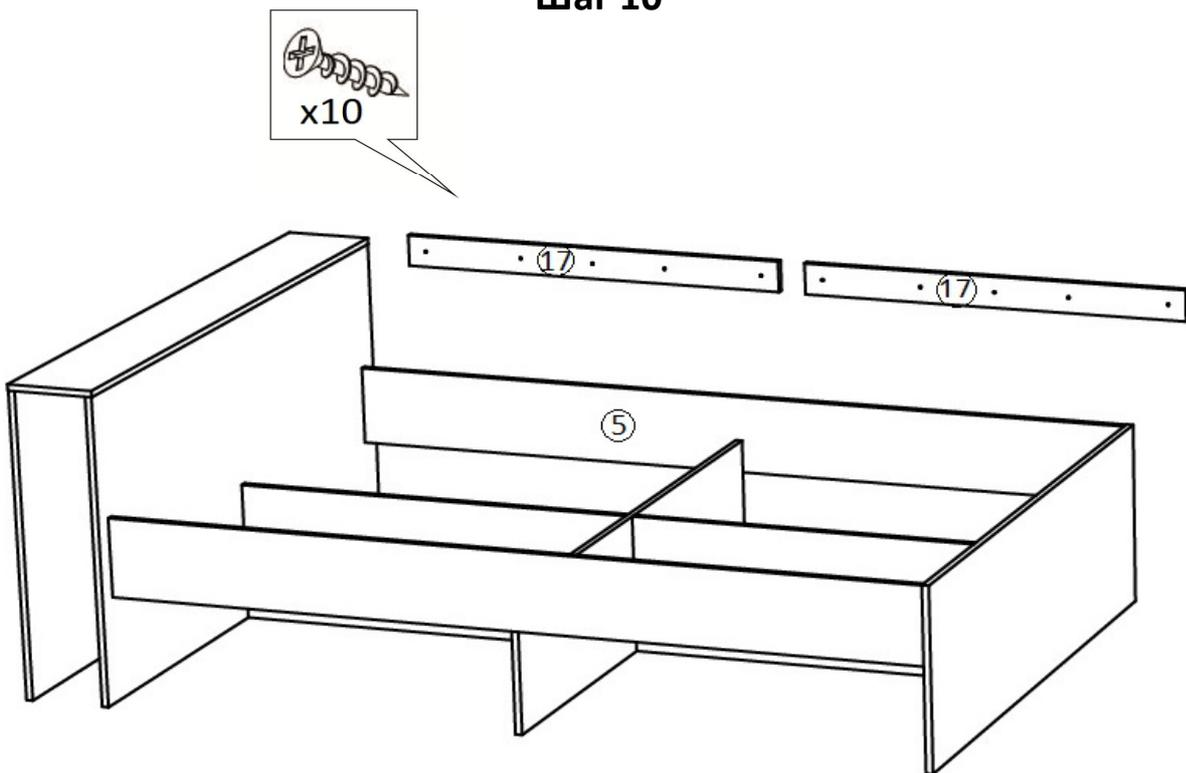
К царге (поз.5), по наколкам, установить усилители (поз.17), используя шуруп 3,5x30мм.
