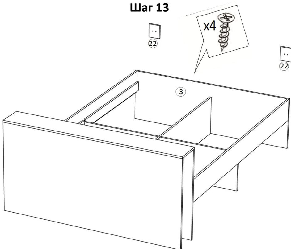
К изножью(поз.3), по наколкам, установить усилители(поз.22), используя шуруп 3,5х30мм.
