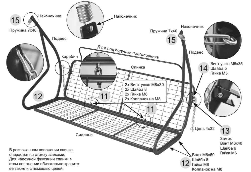
В разложенном положении спинка опирается на стяжку замками. Для надежной фиксации спинки в этом положении обязательно крепите ее также и с помощью цепей.
