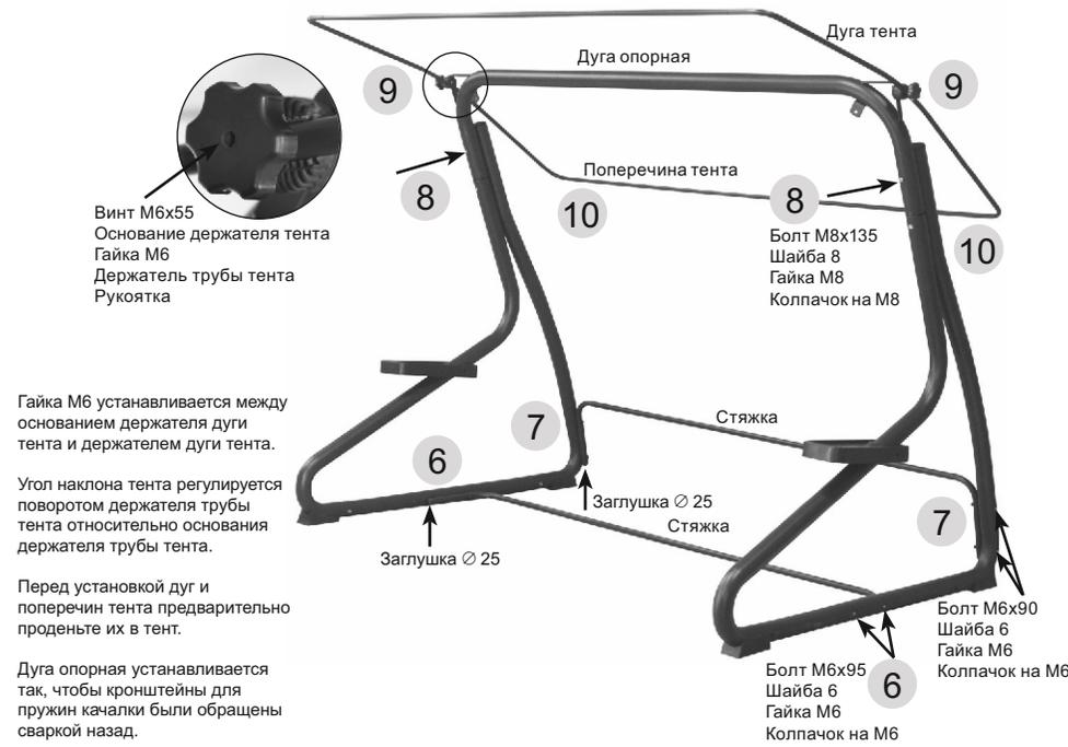
Гайка М6 устанавливается между основанием держателя дуги тента и держателем дуги тента.
