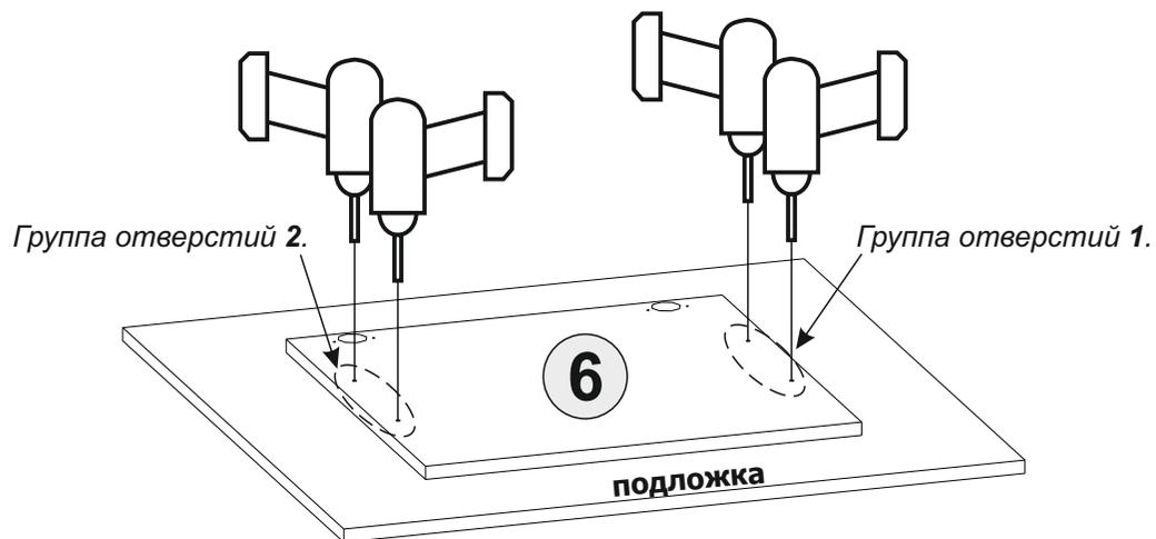
Досверлить до сквозного
