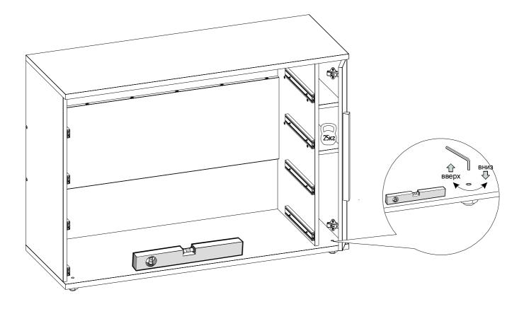
11 Установить заднюю стенку. Прямоугольность собранного каркаса проверить рулеткой по диагонали.
