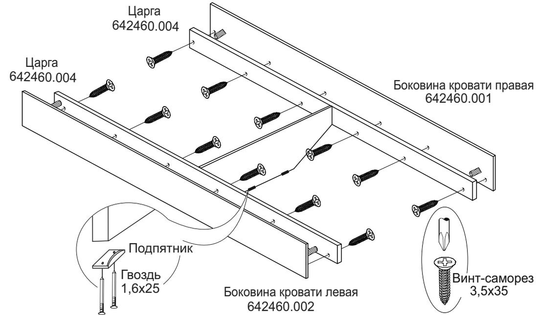
Затянуть эксцентрик через отверстие в царге  $\varnothing 10$  мм
