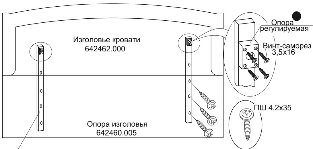
Прикрутить усилитель спинки при помощи Саморез ПШ 4,2x35
