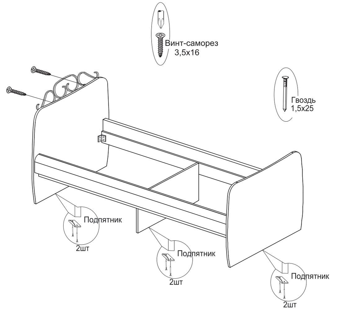
Накладку декоративную прикрутить винтом-саморезом 3,5x16.
