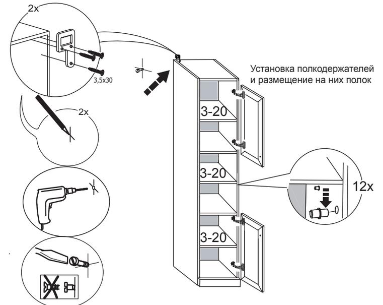
7 При установке нескольких шкафов, рекомендуется скрепить их между 2х собой стяжными винтами
