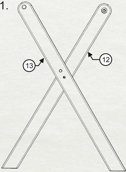
1. Отсортируйте **стойки (12 и 13)**. Должны получиться два крестика с расположением отверстий как на рис. 1
