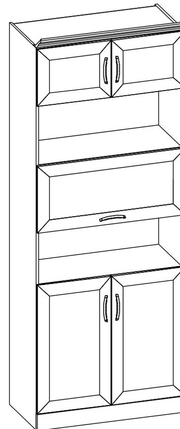
После сборки соедините шкаф с соседним элементом из набора "Александрия" стяжкой межсекционной, предварительно просверлив отверстия диаметром 5мм.
