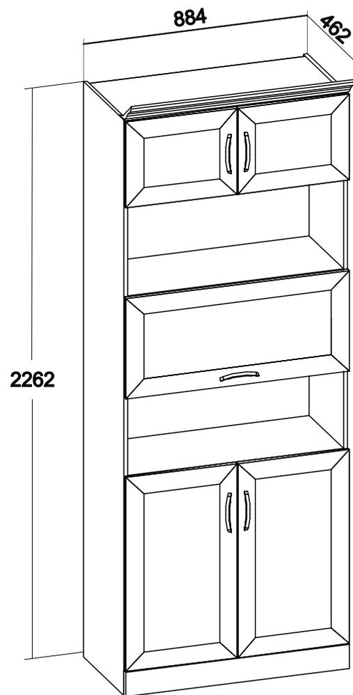
Карниз приобретается отдельным модулем и крепится Винтом-саморезом 3x20
