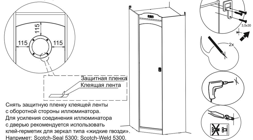
Снять защитную пленку клеящей ленты с оборотной стороны иллюминатора. Для усиления соединения иллюминатора с дверью рекомендуется использовать клей-герметик для зеркал типа «жидкие гвозди». Например: Scotch-Seal 5300; Scotch-Weld 5300.
