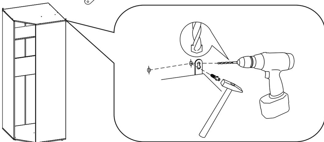
Для избежания повреждения газовых, вентиляционных водопроводных отверстий и электрических коммуникаций, обратите внимание на их расположение!
