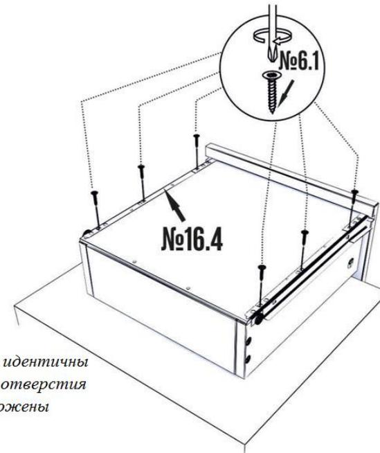
*Примечание: Боковины ящика левая и правая идентичны друг другу. При сборке надо учитывать, что отверстия под бочонки на одной боковине будут расположены внутри ящика, на другой снаружи.*
