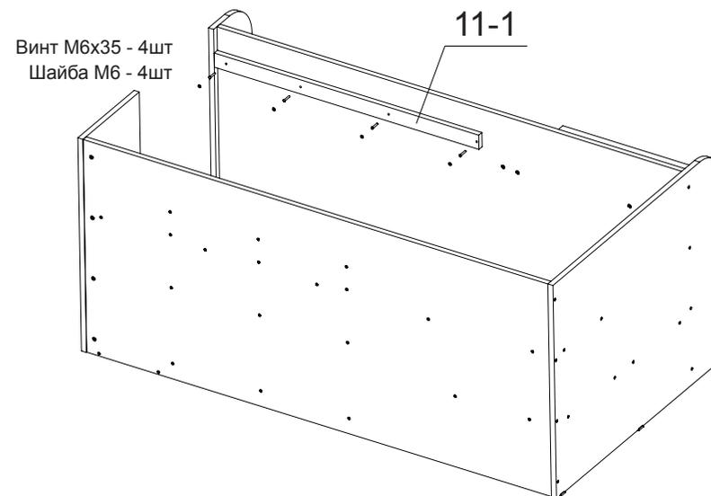
24 Установка подъемного механизма и магнитной защелки
