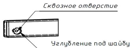
**Монтаж гаек врезных.** Вбивайте врезные гайки в дерево молотком так, чтобы лицевая грань гайки находилась на одном уровне с деревом.
