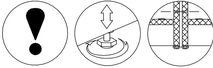
При установке изделий рядом друг с другом, необходимо просверлить отверстия диаметром 5мм в стойках изделий и стянуть через них межсекционной стяжкой №13,14. Внимание: изделия должны быть выровнены по высоте и глубине.
