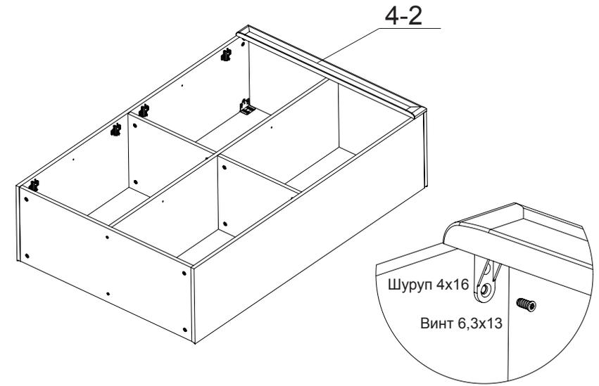
2.5 Крепление опор и стенок задних
