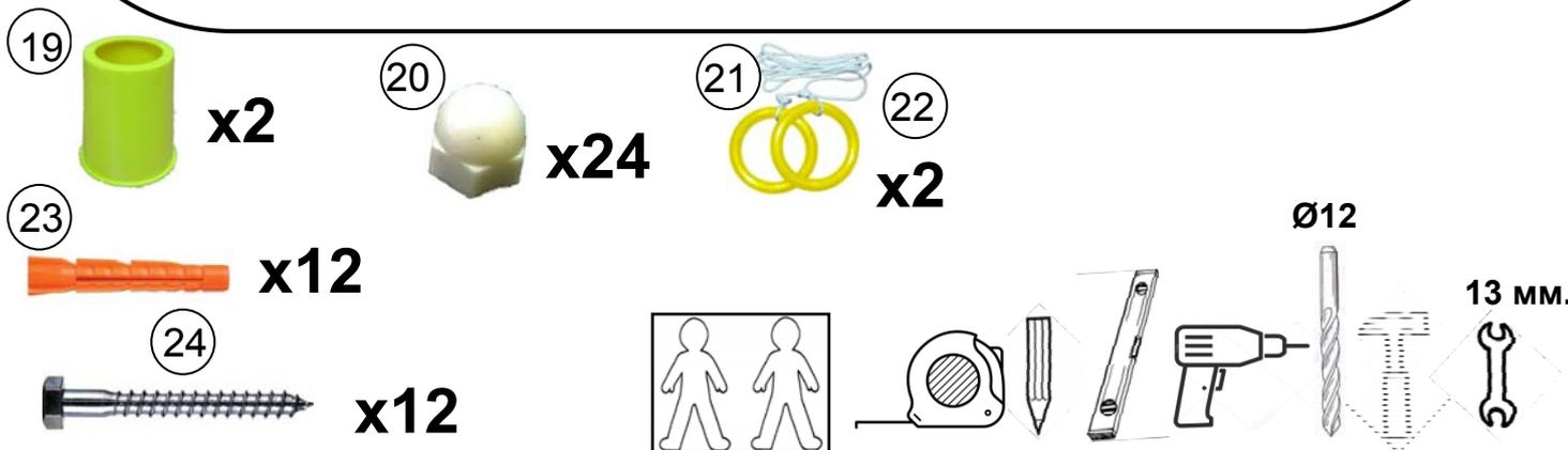
**12.** На заранее выбранном месте установите КОМПЛЕКС и наметьте места под отверстия в стене под дюбеля, просверлите отверстия по намеченным местам. Вставьте дюбеля (23) в отверстия в стене. **(А)**
