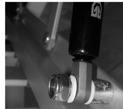
Рис. 14 (Фторопластовые шайбы и гайка со стопорным кольцом)
