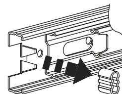
Для улучшения работы направляющей при установке доводчика извлечь резиновый ограничитель хода с направляющей.
