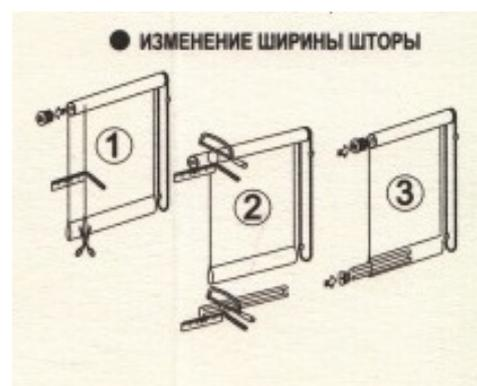
трубу на 4 мм от края ткани. Обрезать утяжелитель. Длина утяжелителя должна быть на 10-15 мм короче ширины ткани.
