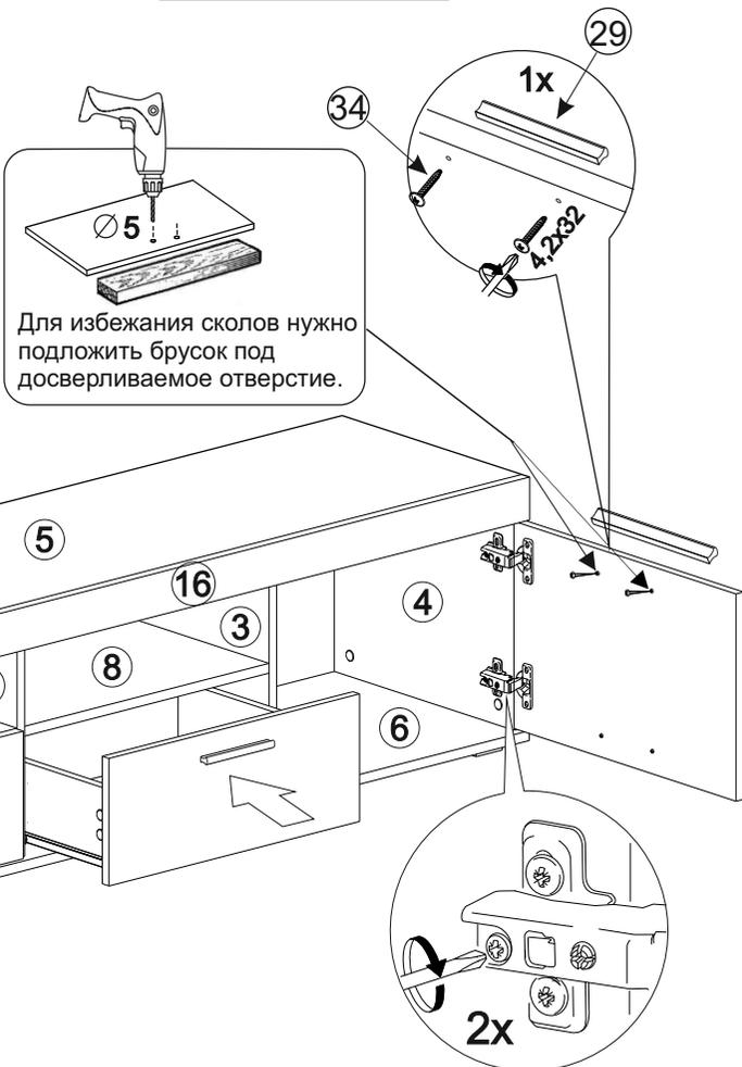
**РЕГУЛИРОВКА ДВЕРНЫХ ПЕТЕЛЬ:**
