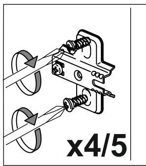
Выберите сторону открывания дверей и установите монтажные планки на боковые панели в указанные отверстия согласно вашей комплектации
