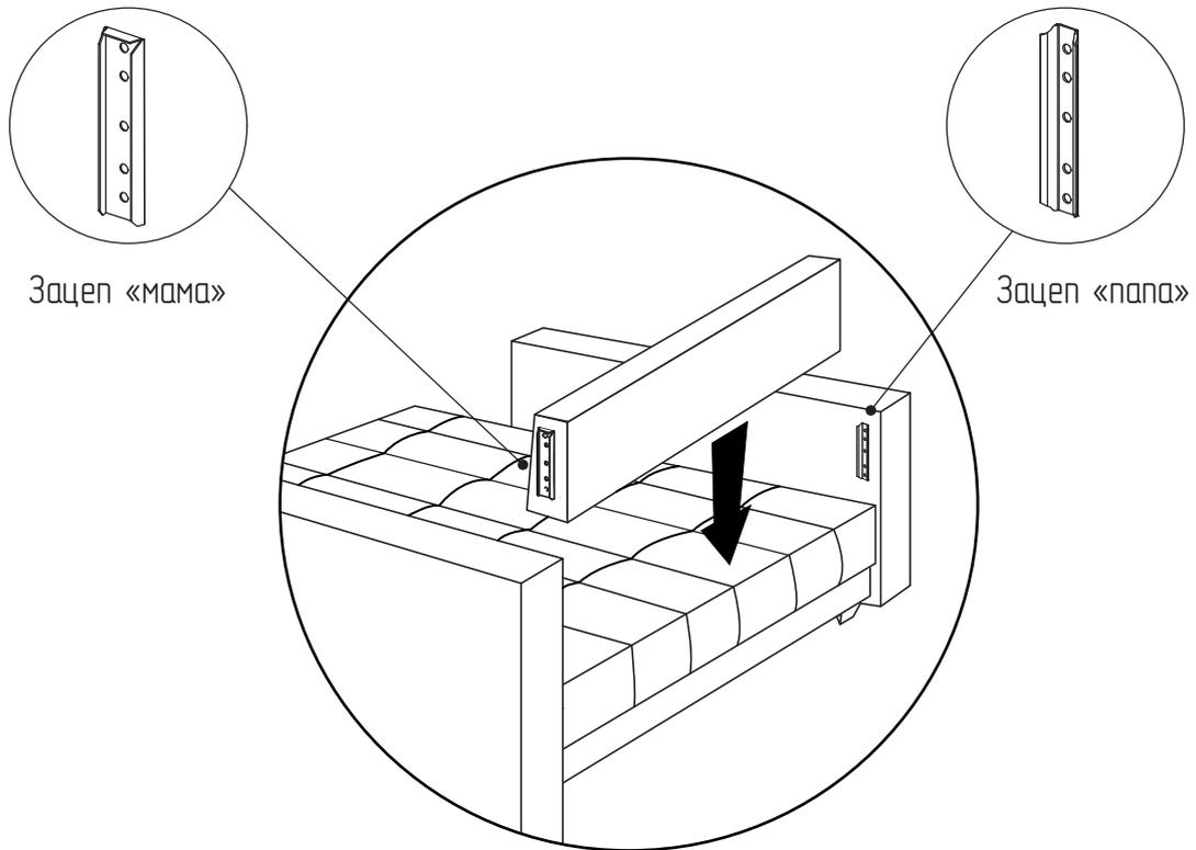
⑤ Прижать подлокотники к сиденью максимально плотно. Поднять раскладную часть. Затянуть фиксирующие болты M8×20.
