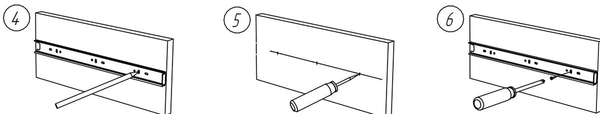
Соблюдая технологические отступы от переднего края деталей необходимо приложить элементы направляющих на линии разметки и отметить, через предусмотренные отверстия в направляющих, места их будущего крепления (достаточно 3-х точек крепления для каждого элемента выдвигной направляющей).
