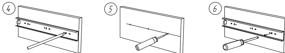
Соблюдая технологические отступы от переднего края деталей необходимо приложить элементы направляющих на линии разметки и отметить, через предусмотренные отверстия в направляющих, места их будущего крепления (достаточно 3-х точек крепления для каждого элемента выдвигной направляющей).
