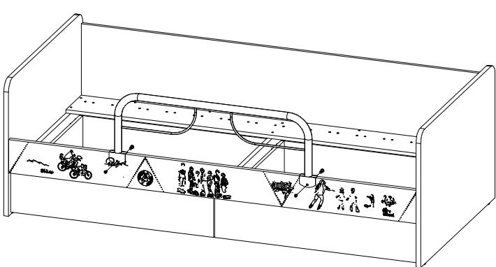
Для фиксации ограничителя (опционально) необходимо установить его в требуемое положение и через имеющиеся в держателях отверстия просверлить сверлом диаметром 10мм отверстия в планке №11, затем закрепить его с помощью фурнитуры идущей в комплекте с ограничителем.
