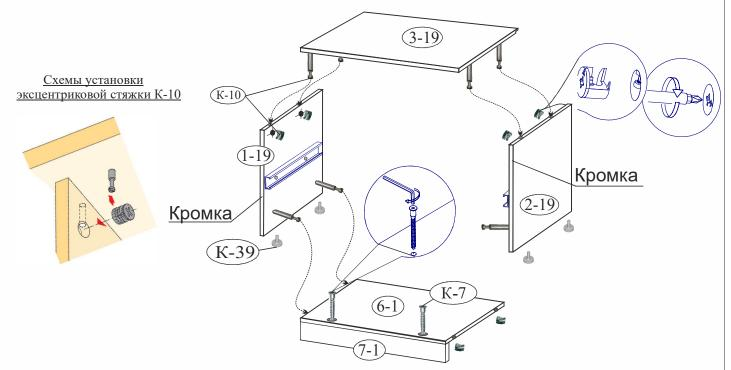
4. Положите каркас на пол кромками вниз, выровняйте (замерив проемы по диагонали), установите стенку заднюю (поз. 5-19) в четверть на колпаке верхнем и закрепите к стенкам вертикальным шурупами с шайбами (К-45) с градацией 150 мм.
