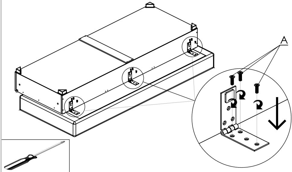
4. После того, как винты затянуты, вкрутить саморез 5x16 мм В (по 1 шт. на петлю). Сильно саморез не затягивать, так как есть вероятность прокрутить резьбу.
