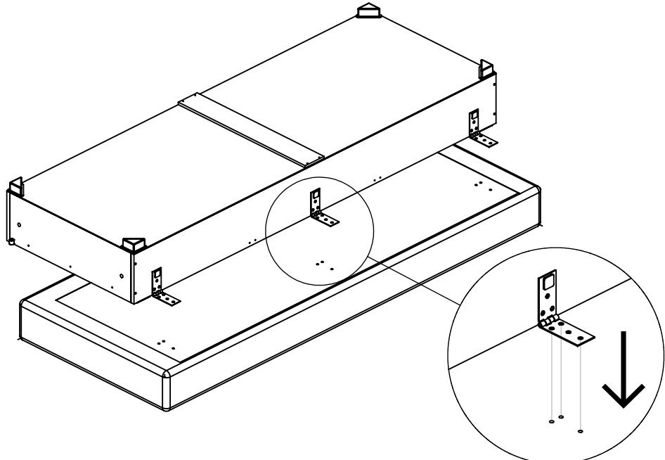
3. Закрепить в посадочных отверстиях с резьбой крыло петли к спинке дивана винтами M6x20 мм А (по 3 шт. на петлю).
