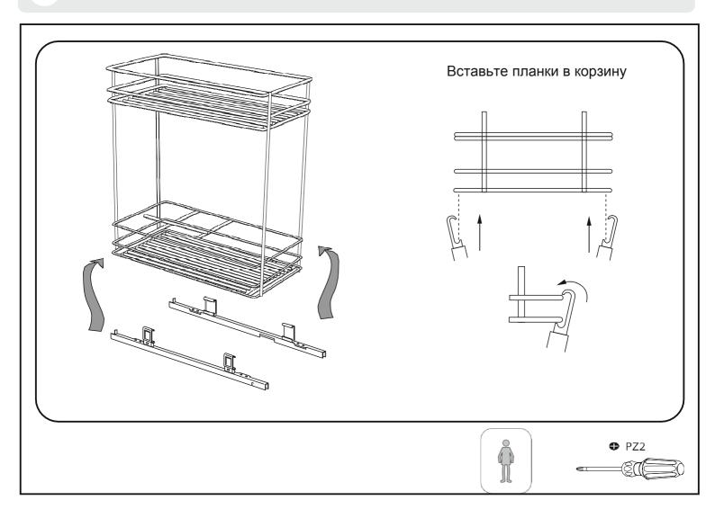
Установите левые и правые кронштейны на корзину с помощью винтов M6. Установите на кронштейны регулировочные винты
