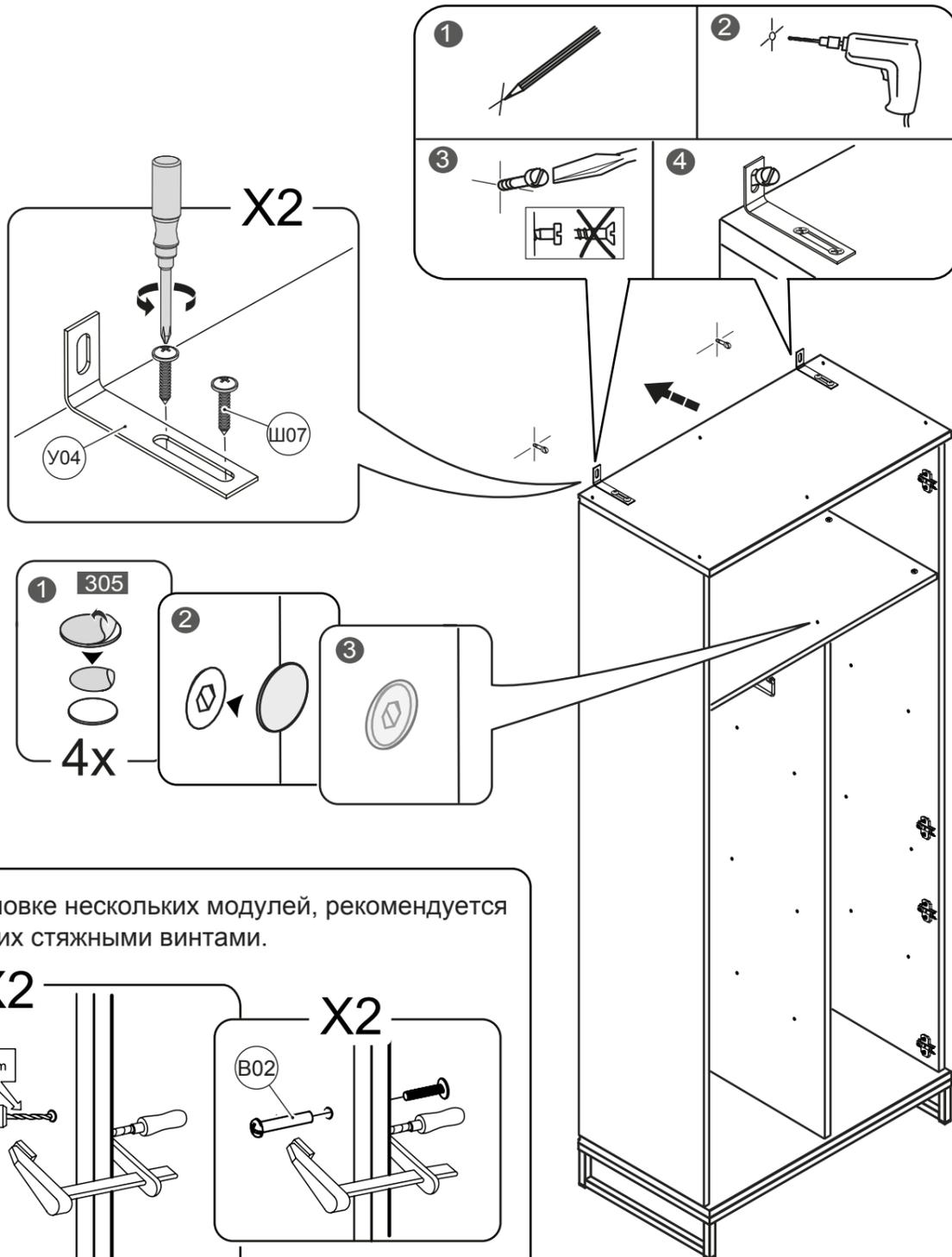
При установке нескольких модулей, рекомендуется скрепить их стяжными винтами.
