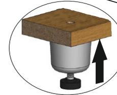
Регулировка высоты осуществляется через сквозное отверстие в дне конструкции, отверстие для регулировки закрывается декоративной заглушкой (в комплекте)
