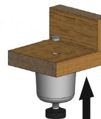
Регулировка высоты опоры осуществляется через сквозное отверстие в дне конструкции, отверстие для регулировки закрывается декоративной заглушкой (в комплекте)
