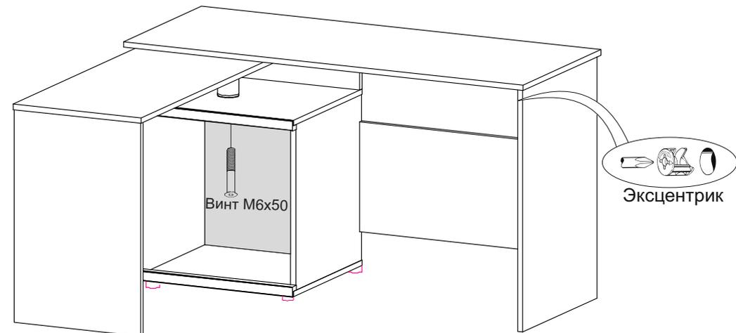
Опору стола поворотную закрепить через крышку тумбы винтом М6х50.
