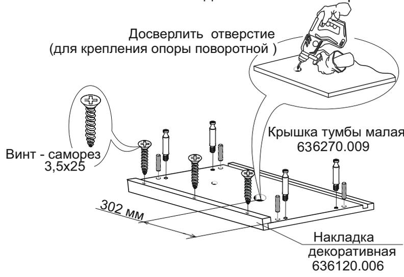
Досверлить отверстие (для крепления опоры поворотной)
