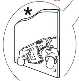
\* Перед тем как крепить царгу по наколкам досверлить отверстия  $\varnothing 7-8$  мм в стенке вертикальной (636270.001).
