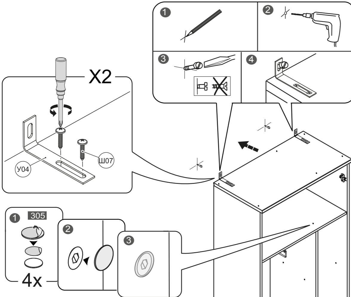
При установке нескольких модулей, рекомендуется скрепить их стяжными винтами.
