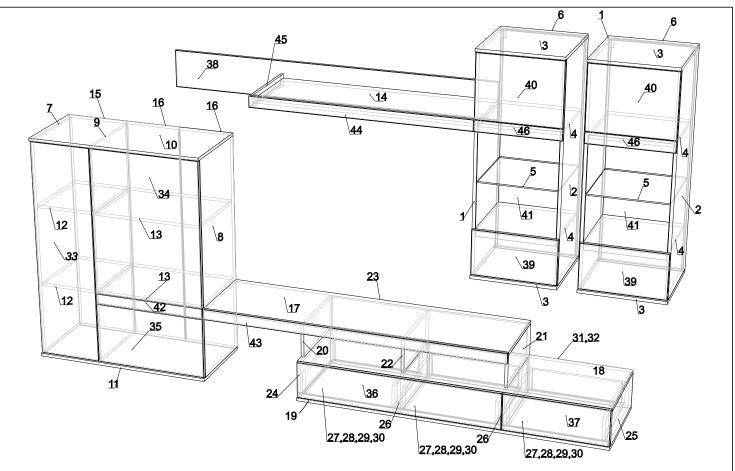
Внимательно ознакомьтесь со схемой сборки, сверяясь с комплектовочной ведомостью на изделие. Согласно комплектовочной ведомости определите расположение деталей в изделии и порядок их сборки. Сборка производится на ровном полу, укрытом материалом, предотвращающим повреждение покрытия пола и деталей мебели. Подготовьте необходимые для сборки инструменты.
