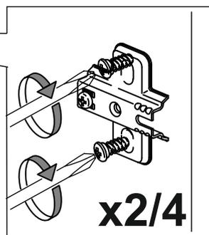
Для шкафов шириной 60 и 80 см возможна установка двух фасадов. В таком случае, монтажные планки установить на обе стороны каркаса
