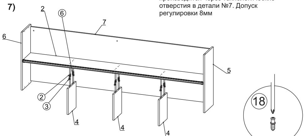
Регулировка расположения полки производится через технологические отверстия в детали №7. Допуск регулировки 8мм
