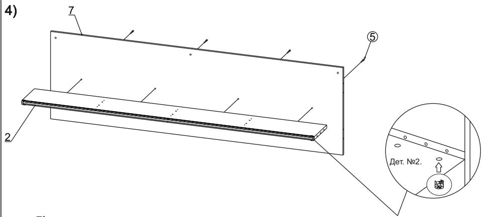
Эксцентриковые стяжки должны быть с нижней стороны детали №2.
