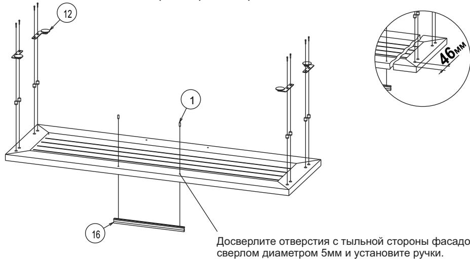
Монтаж и регулировку механизма (позиция №12) производить в соответствии с инструкцией входящей в комплектацию.
