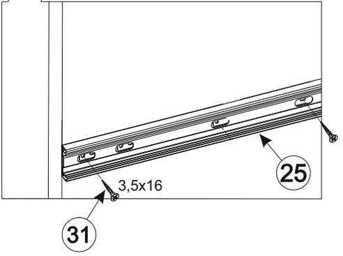
**Порядок монтажа шариковых направляющих полного выдвижения**
