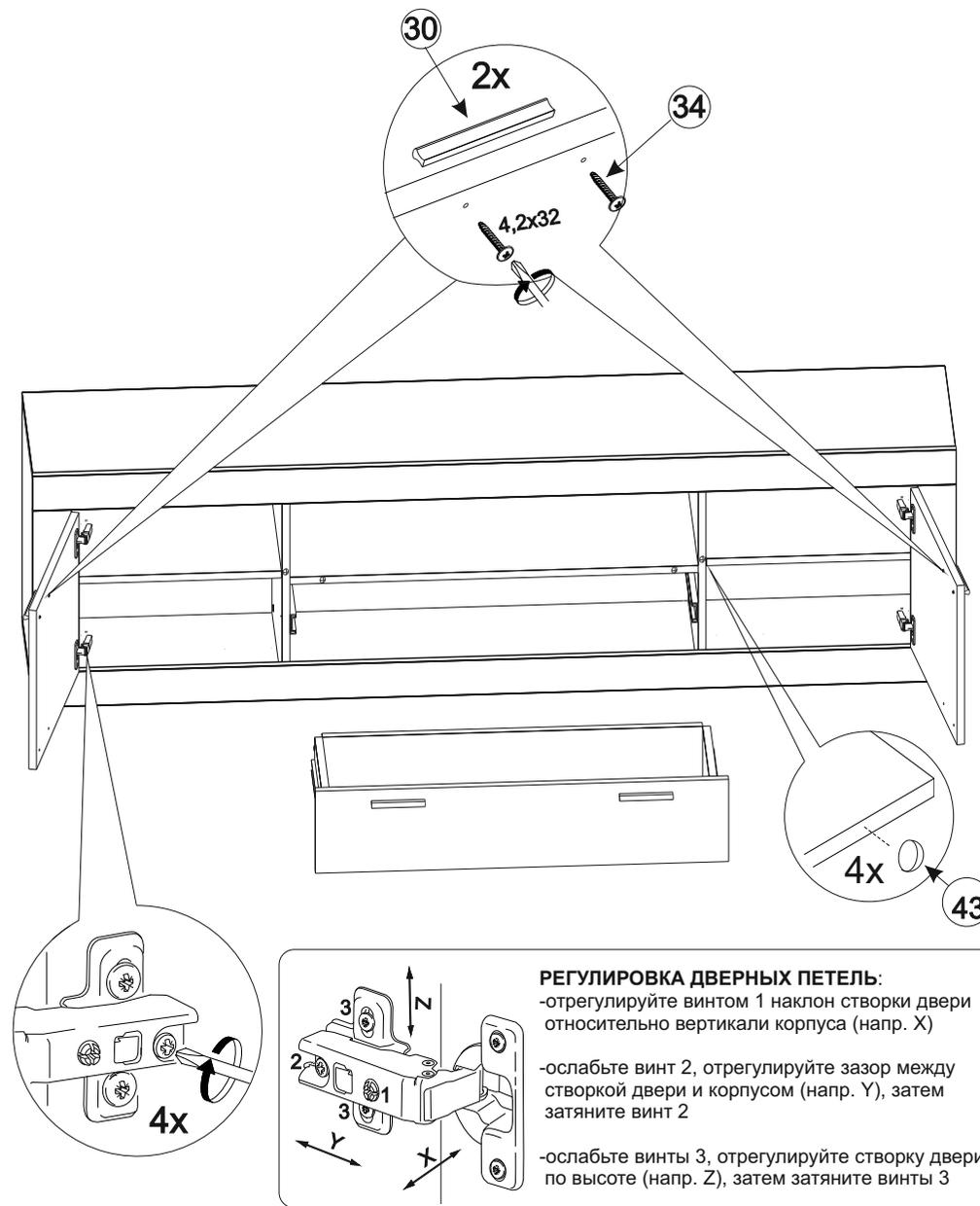
**РЕГУЛИРОВКА ДВЕРНЫХ ПЕТЕЛЬ:**
