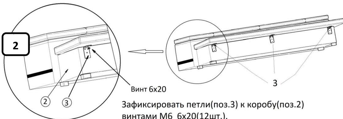
Зафиксировать петли(поз.3) к коробу(поз.2) винтами М6 6x20(12шт.).
